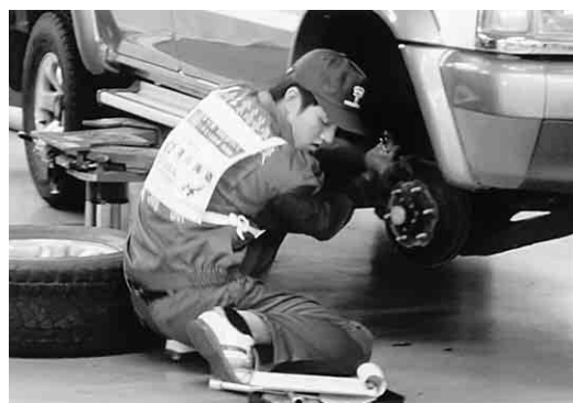
課題Ⅲの定期点検においてブレーキパッドの点検を実施
